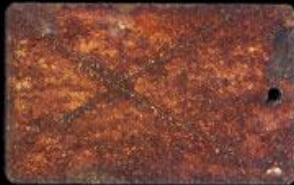
Rust-oleum® Rusty Metal Primer Topcoated with Rust-oleum® Gloss Enamel
